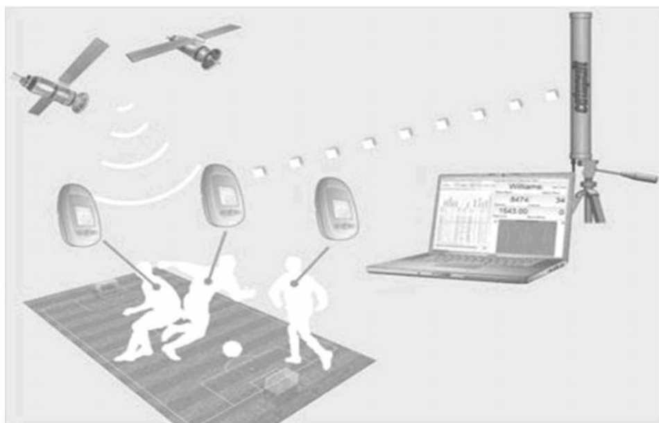
Figura 1. Antena conectada al ordenador que detecta en tiempo real la ubicación y velocidad de los jugadores.
